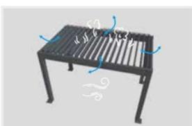
L'aria calda può essere convogliata fuori dalle lamelle mantenendo ventilazione e dissipazione del calore
