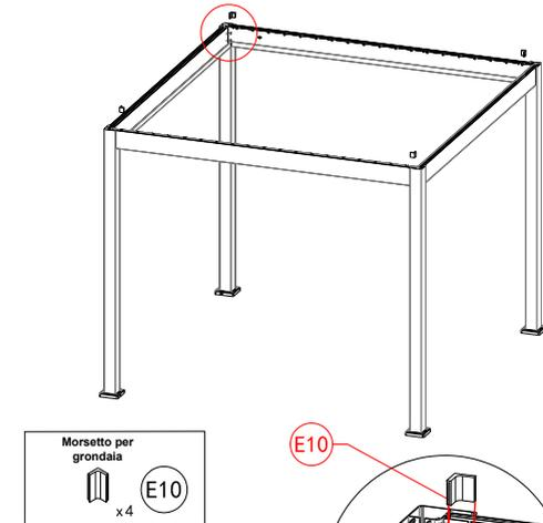
Installare il morsetto della grondaia nell'angolo della grondaia e sigillare l'interno del morsetto della grondaia con silicone
