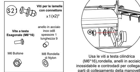
Usa le viti a testa cilindrica (M6\*16), rondella, anelli in acciaio inossidabile e controdadi per collegare le parti di collegamento della manovella e collegare la feritoia della manovella (mettere la rondella tra la base di montaggio e il cappuccio terminale della lama).
