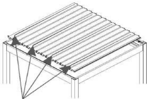
Mettere l'asta di rotazione delle lamelle nel supporto in plastica presente nel trave. Si suggerisce di posizionare una lamella con ludi led ogni 3 lamelle senza led.
